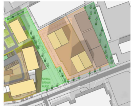
Viitekuva 2 Massoittelussa hyväksyttyjä vaihtoehtoja, viitesuunnitelman kerrosala 5750 k-m 2 , kaksi pistemäistä VII-kerroksista rakennusta, joissa tulee olla harjakatto; Järvenpään kaupunki.
