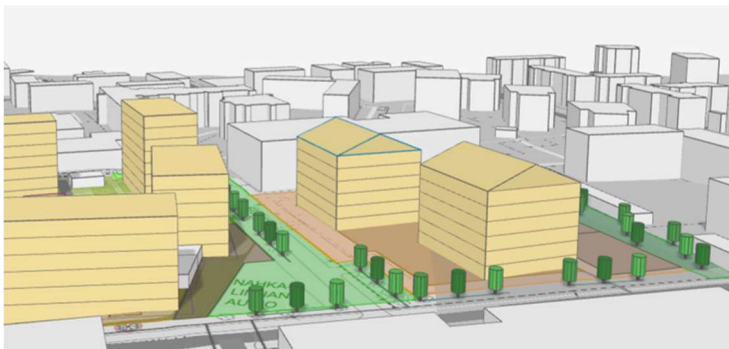
Viitekuva 3 Massoittelussa hyväksyttyjä vaihtoehtoja, viitesuunnitelman kerrosala 5610 k-m 2 , kaksi VI-kerroksista rakennusta, joissa tulee olla harjakatto; Järvenpään kaupunki.
