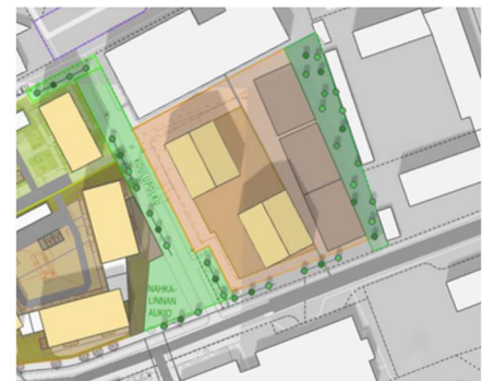
Viitekuva 3 Massoittelussa hyväksyttyjä vaihtoehtoja, viitesuunnitelman kerrosala 5610 k-m 2 , kaksi VI-kerroksista rakennusta, joissa tulee olla harjakatto; Järvenpään kaupunki.
