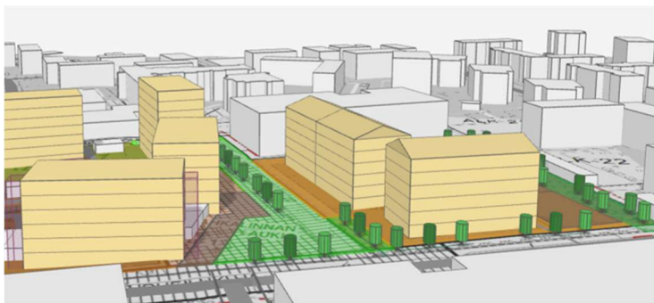
Viitekuva 1 Massoittelussa hyväksyttyjä vaihtoehtoja, viitesuunnitelman kerrosala 6000 k-m 2 , kolme VI-kerrosta rakennusta, joissa tulee olla harjakatto; Järvenpään kaupunki.
