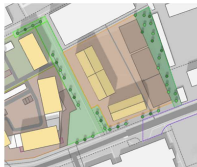
Viitekuva 1 Massoittelussa hyväksyttyjä vaihtoehtoja, viitesuunnitelman kerrosala 6000 k-m 2 , kolme VI-kerrosta rakennusta, joissa tulee olla harjakatto; Järvenpään kaupunki.
